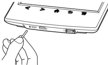
Нажмите кнопку RESET с помощью булавки или скрепки.
